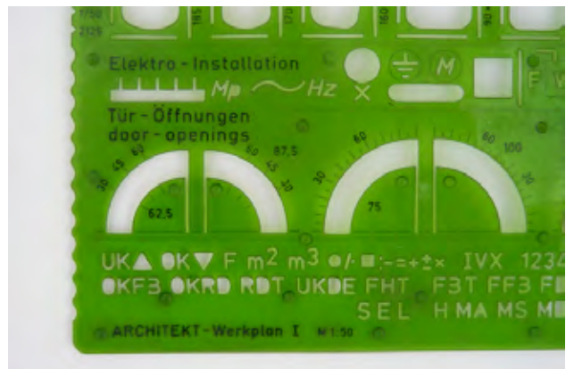
Plantilla múltiple de delineación que recuerda la practicidad con que el profesional ha resuelto tradicionalmente determinadas codificaciones gráficas, bien de forma estandarizada o personalizada.
